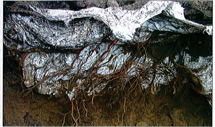
Abb. 3: Wurzelwuchs entlang einer Grenzfläche (Substrat-Kunststoffolie)
